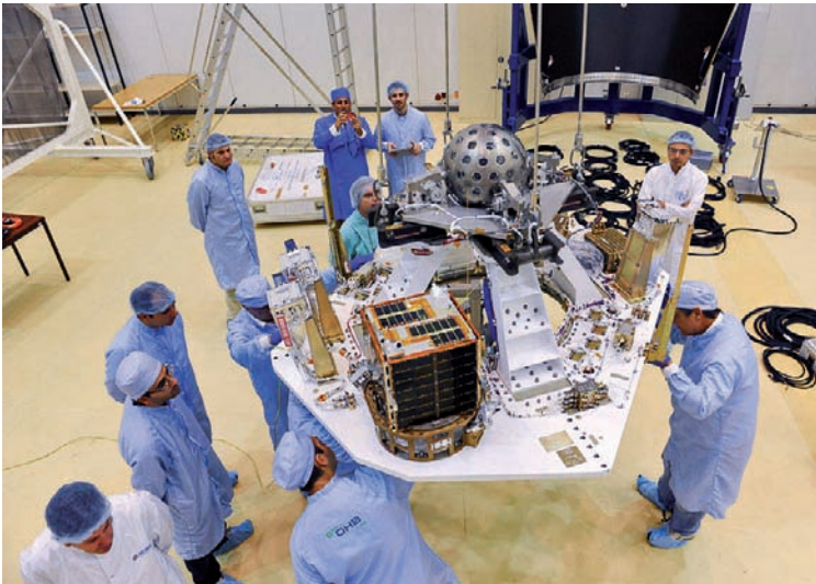
Sopra, il satellite italiano LARES che studierà l'effetto Lense-Thirring, con in primo piano il satellite ALMASat-1, posizionati sul sistema di rilascio che sarà racchiuso nell'ogiva del razzo VEGA. A destra, un primo piano di LARES: notare i retro riflettori che verranno utilizzati per studiare l'effetto Lense-Thirring mediante l'invio di un raggio laser da Terra. [ESA]
